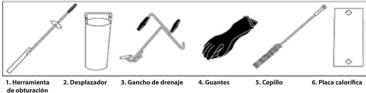
Fig. S – Herramientas de la freidora
