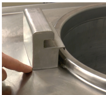
Rys. G – Uszczelka przedniego bloczku
